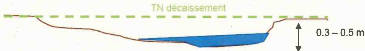
Profil en travers type de création du dépression humide (source : setec)
